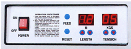
數位式顯示送帶長度及捆包緊度
